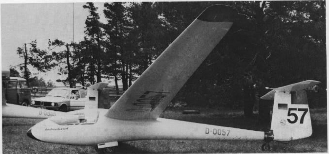
Ein Phoebus C mit 17 m Spannweite und Einziehfahrwerk.
