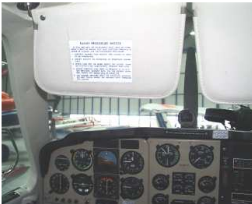
Abb. 16: Sichteinschränkung durch Sonnenblenden in einem Motorflugzeug-Cockpit
