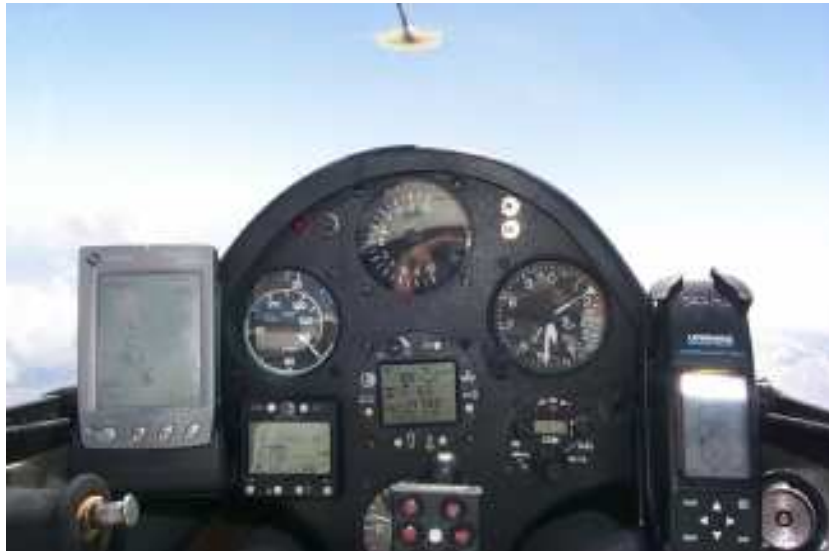
Abb. 15: Sichteinschränkung durch nachgerüstete Elektronik im Segelflugzeug-Cockpit
